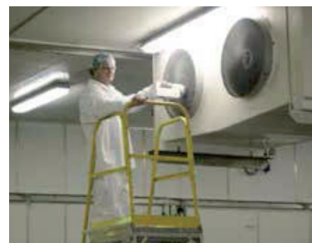
Erfassung der Keimbelastung aus/in den Umluftkühlern (Fotos: Just in Air)
